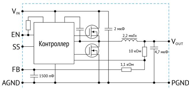
Рис. 3. Упрощённая структурная схема VNA3L0,87,0SQ.
