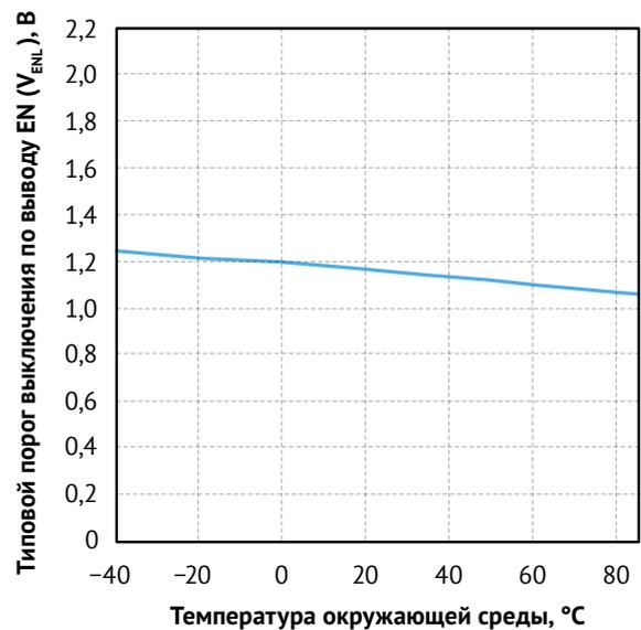
Рис. 19. Зависимость порога  $V_{ENL}$  от температуры.
