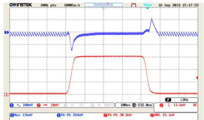
Рис. 9.  $I_{OUT} = 0,1-3 \text{ A}$ ;  $0,1 \text{ A/мкс}$ .
