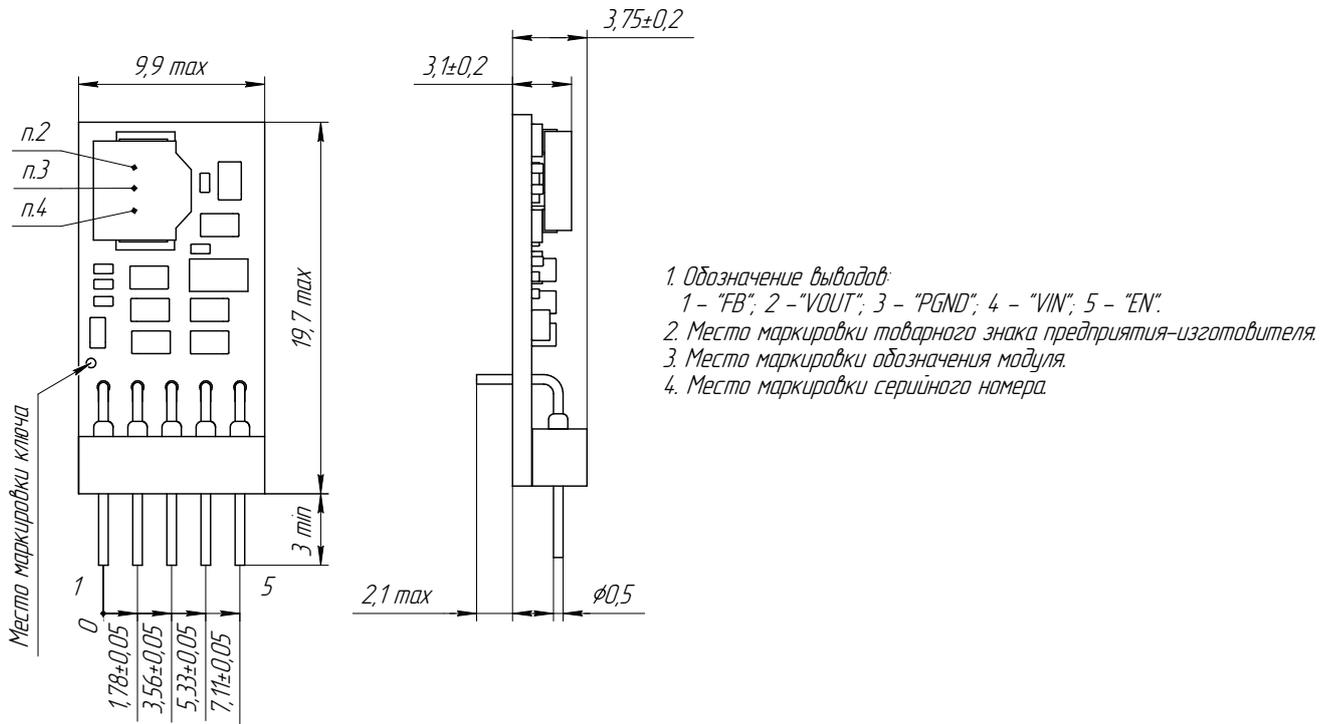
Рис. 30. Габаритный чертеж и обозначение выводов VNA3L0, 87, OSP.
