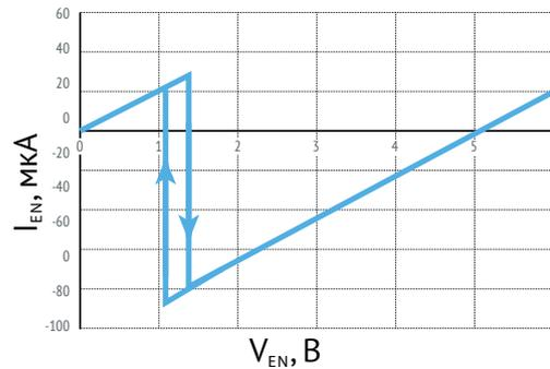
Рис. 17. Типовой гистерезис включения/выключения модуля по выводу EN.
