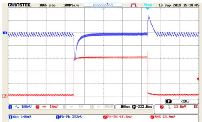
Рис. 8.  $I_{OUT} = 0,1-3 \text{ A}$ ;  $6,5 \text{ A/мкс}$ .
