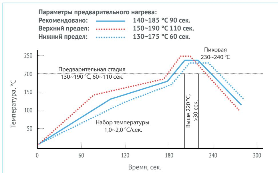
Рис. 28. График и рекомендации по настройке термопрофиля оплавления в печи конвекционного нагрева.
