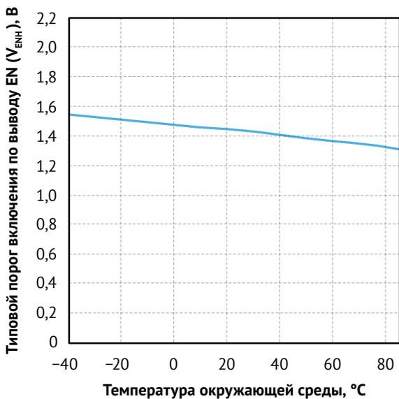
Рис. 18. Зависимость порога  $V_{ENH}$  от температуры.
