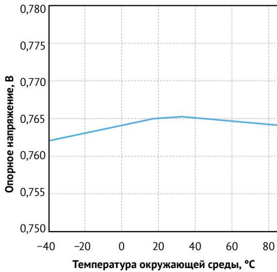
Рис. 20. Типовая зависимость опорного напряжения от температуры.  $V_{IN} = 12\text{ В}$ .
