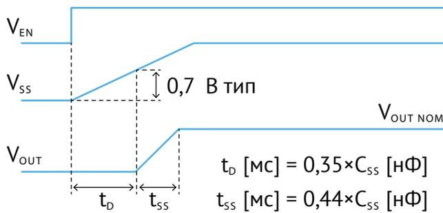
Рис. 21. Диаграмма включения модуля с использованием функции «Плавный старт».
