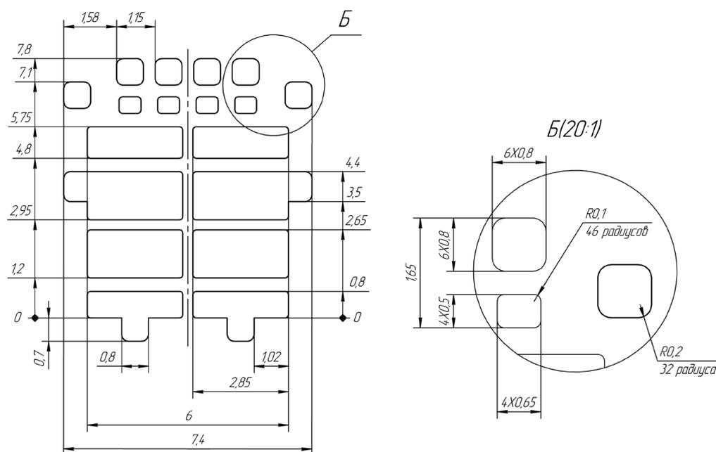
Рис. 26. Пример апертур паяльной пасты для трафарета толщиной 0,1 мм / Solder paste example based on 0.1 mm thick stencil.
