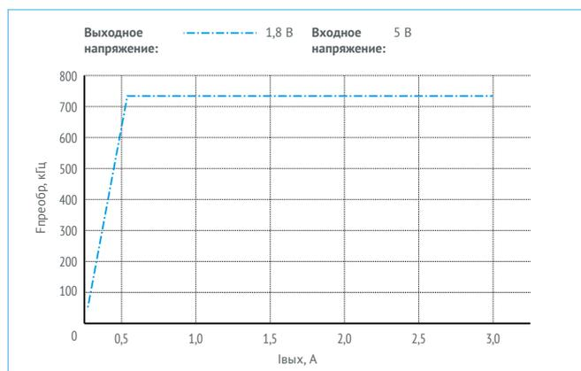
Рис. 6. Зависимость частоты преобразования от тока нагрузки.
