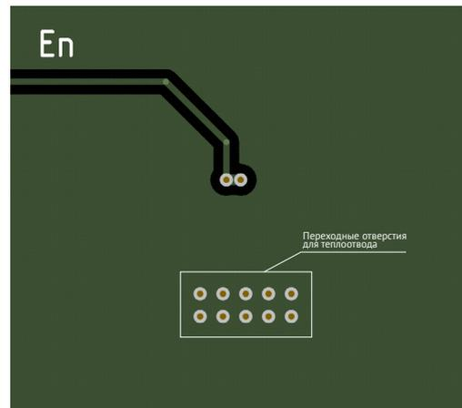
Рис. 24. «Bottom» печатной платы (пример, фрагмент платы).
