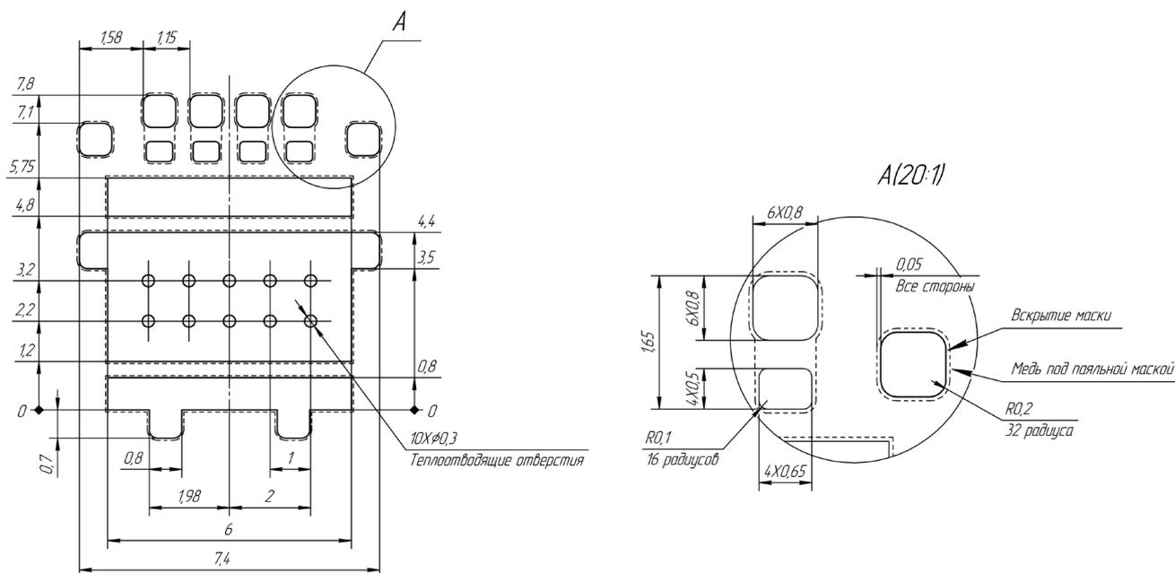
Рис. 25. Пример посадочного места на n/n (слой меди «пунктир.линия»/вскрытие маски «сплошная линия») / Land pattern example.
