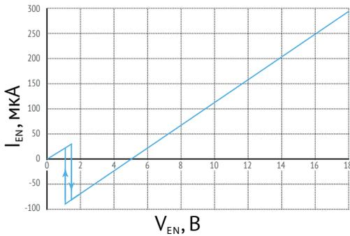
Рис. 16. Типовая кривая втекающего/вытекающего тока по выводу EN в зависимости от напряжения на нем.  $V_{IN} = 18$  В.
