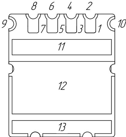
Рис. 2. Расположение выводов модуля VNA3L0,87,0SQ (вид снизу).
