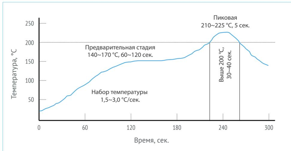
Рис. 27. График и рекомендации по настройке термопрофиля в печи конвекционного нагрева.
