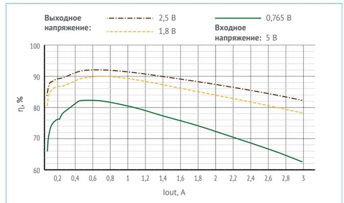
Рис. 14.  $V_{IN} = 5\text{ В}$ ;  $V_{OUT} = 0,765\text{ В}; 1,8\text{ В}; 2,5\text{ В}$ .
