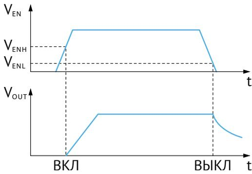
Рис. 15. ВКЛ/ВЫКЛ в зависимости от  $V_{EN}$
