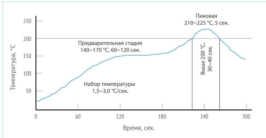
Рис. 8. График и рекомендации по настройке термопрофиля в печи конвекционного нагрева.
