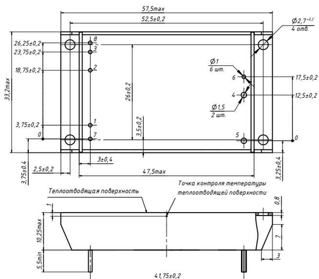
Рис. 11. Исполнение в усиленном корпусе с фланцами.
