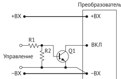
Рис. 3 (б). ВКЛ/ВЫКЛ с помощью биполярного транзистора.
