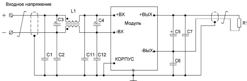
Рис. 2. Типовая схема подключения VDR75 и VDR100.
