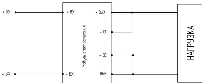
Рис. 5. Типовая схема включения без использования выносной ОС.
