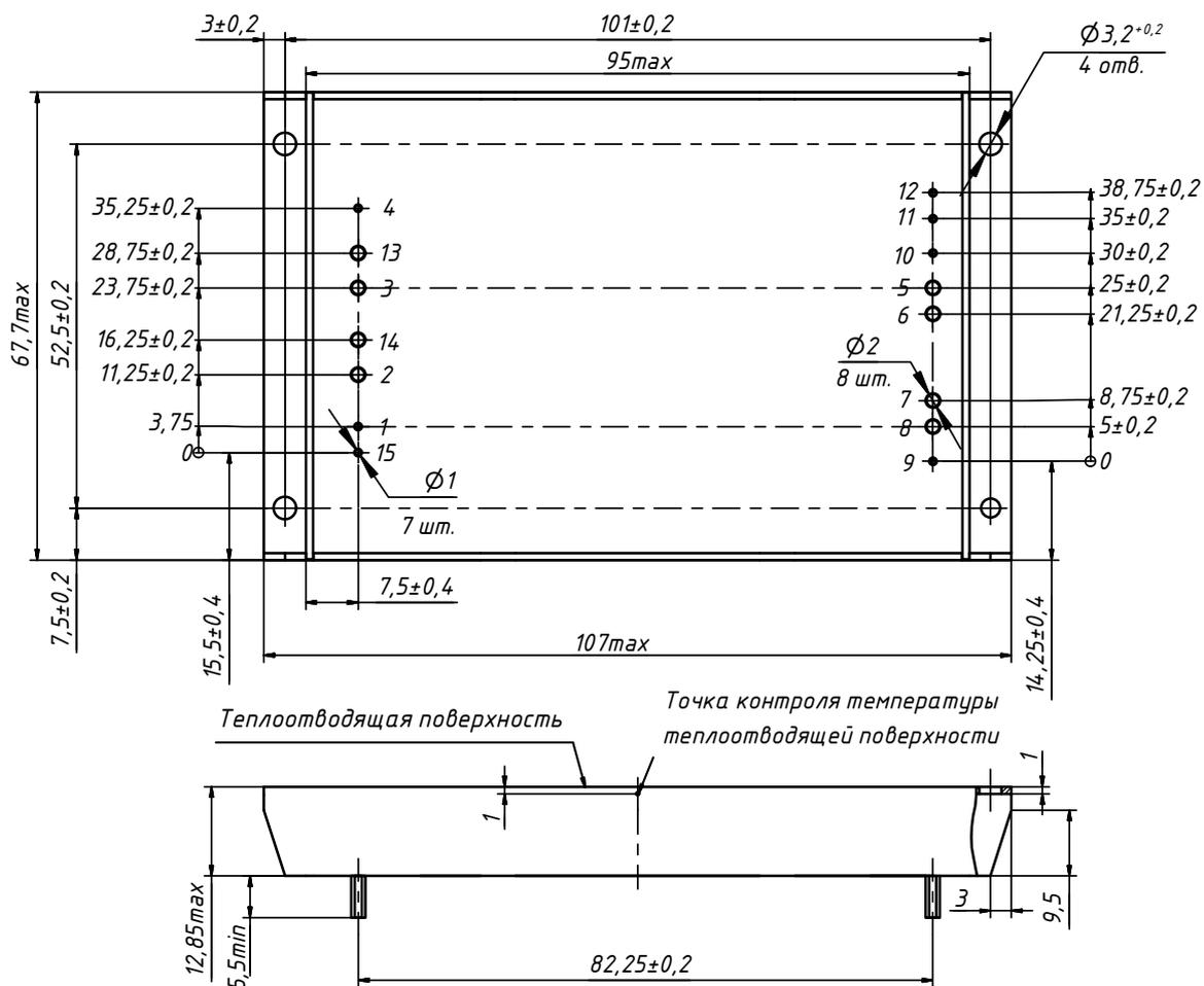
Рис. 6. Исполнение в усиленном корпусе с фланцами.
