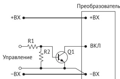
Рис. 2 (б). ВКЛ/ВыКЛ с помощью биполярного транзистора.
