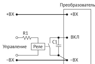
Рис. 2 (а). ВКЛ/ВыКЛ с помощью реле.
