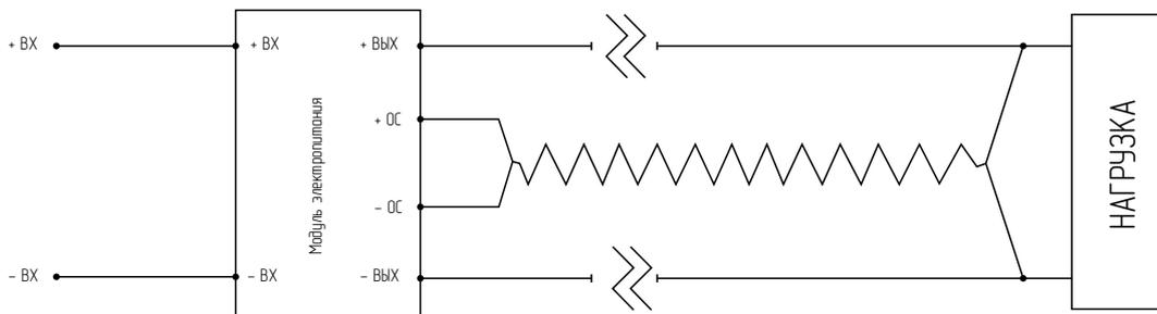
Рис. 4. Типовая схема включения выносной ОС.
