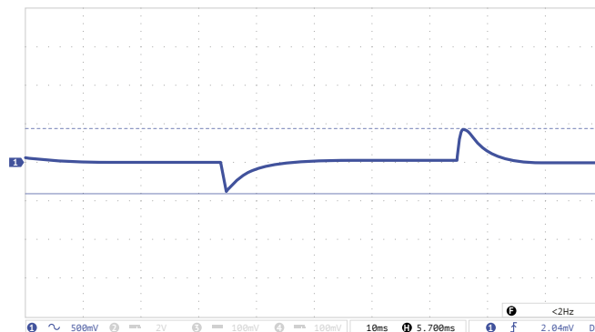
Рис. 8 (г). Осциллограмма переходного отклонения выходного напряжения при изменении выходного тока.
