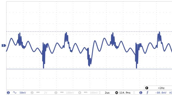
Рис. 9 (в). Осциллограмма пульсаций выходного напряжения.
