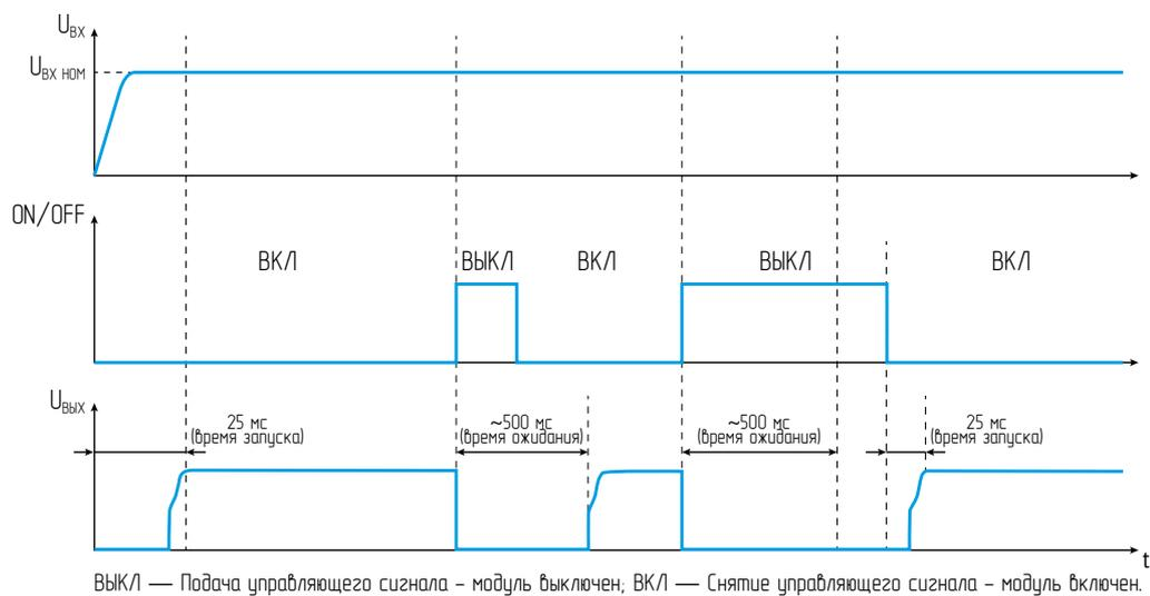
Рис. 4. Циклограмма режима работы дистанционного выключения модулей VDMC25.
