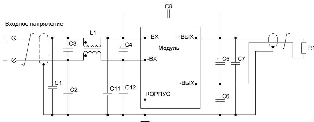
Рис. 2. Типовая схема подключения VDN10.
