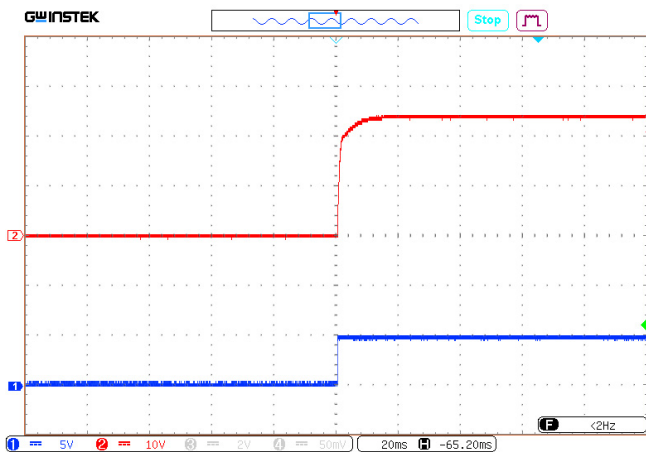
Рис. 12 (а). Осциллограмма установления выходного напряжения с момента подачи команды дистанционного управления.
