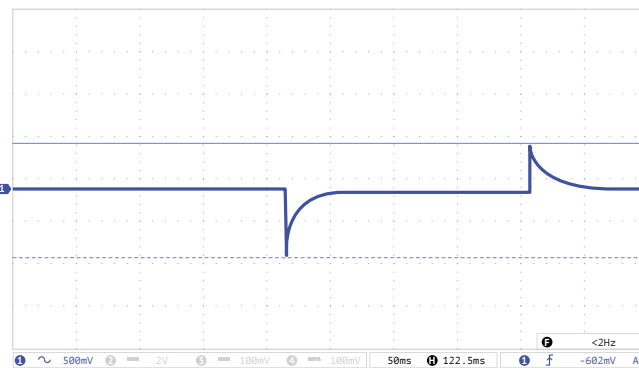
Рис. 9 (г). Осциллограмма переходного отклонения выходного напряжения при изменении выходного тока.
